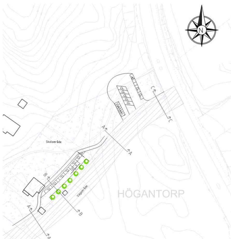
Figur 32. Utformningsförslag i plan för personalparkering i norr och hämta-/lämnaparkering i söder.
