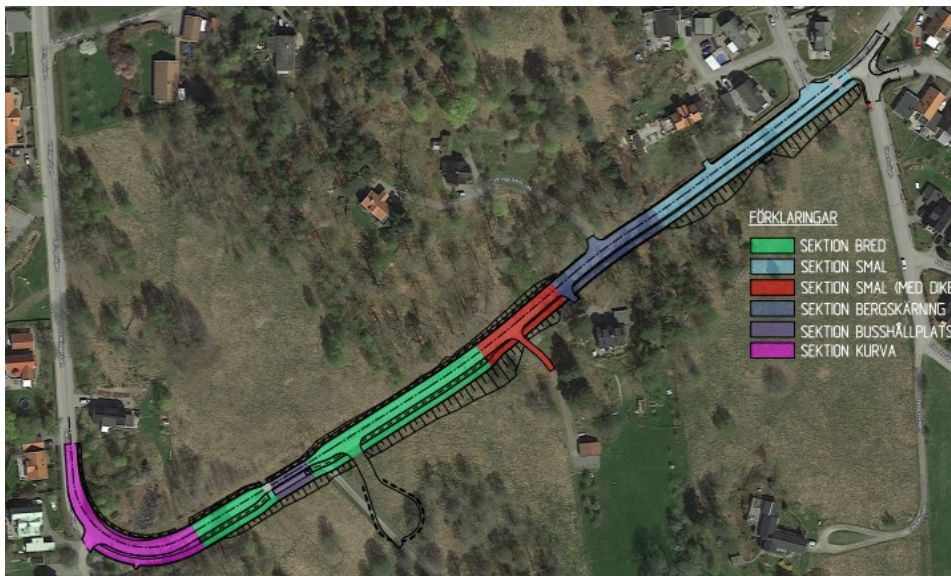
Figur 3 – Sektionsindelning för Uttringe Gårds väg (Underlag: Google Maps)
