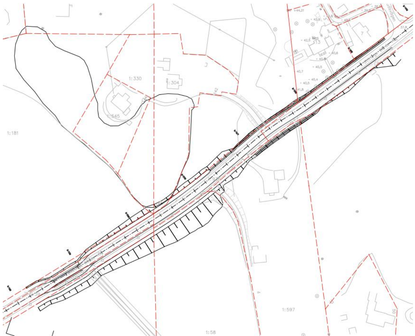
Figur 18. Släntutbredning vid justering av Uttringe gårds väg.
