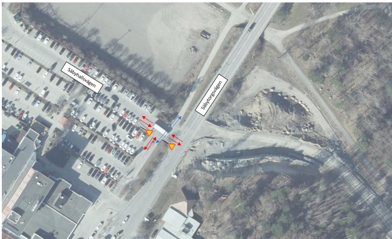
Figur 10. Trafikrörelser i korsning Säbytorgsvägen/Säbyhallsvägen. Röda pilar illustrerar motorfordonsrörelser och blåa pilar gång- och cykeltrafikanter rörelser.
