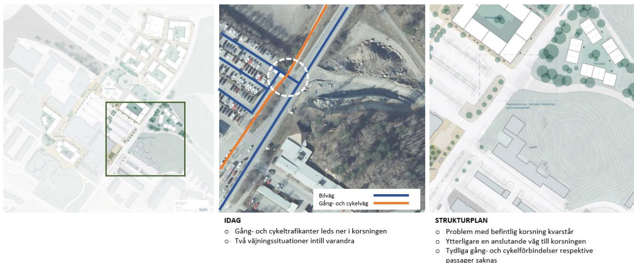
Figur 13. Identifierade befintliga och möjliga framtida problem för korsning Säbytorgsvägen/Säbyhallsvägen.
