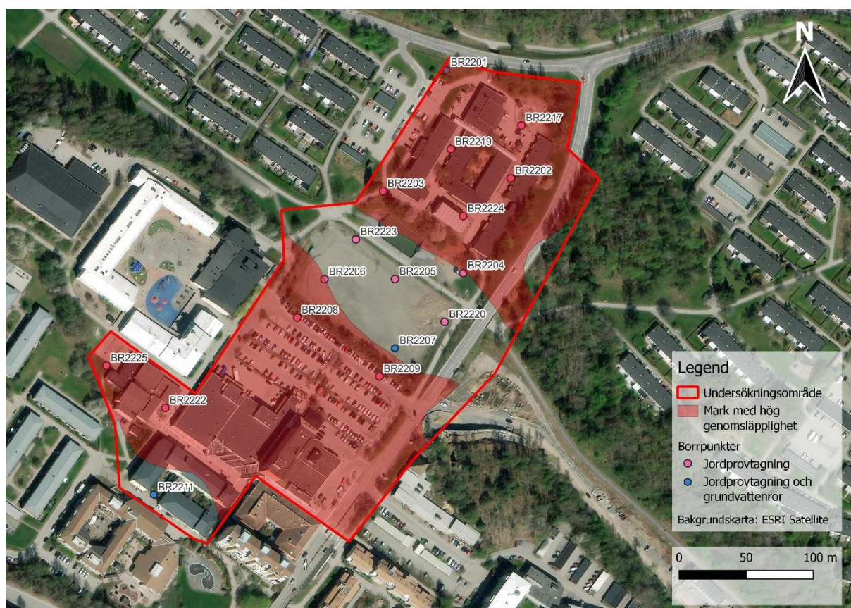
Figur 5 Karta visade områden med hög genomsläpplighet, vilket innebär större spridningsmöjligheter och därmed högre exponeringsrisk med avseende på ångor i byggnader. Information från SGU:s karttjänst.
