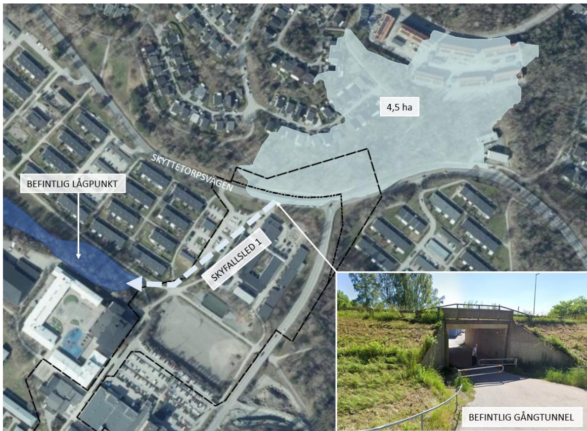
Figur 8 Befintlig skyfallsled norrifrån som rinner igenom utredningsområdet till befintlig lågpunkt i väster.
