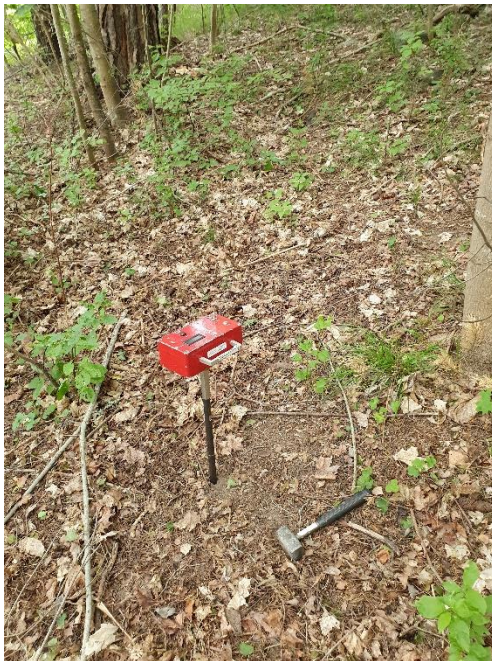
Figur 3. Mätning av radon i jordluft med Markus-10
