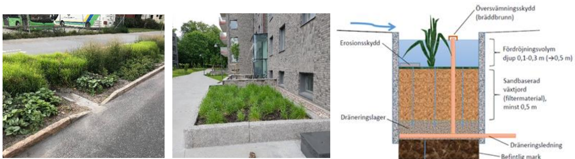
Figur 22. Exempelbilder på hur växtbäddar kan utformas (övre, Bjerking). Principutformning nedsänkt växtbädd (nedre, illustration av WRS).
